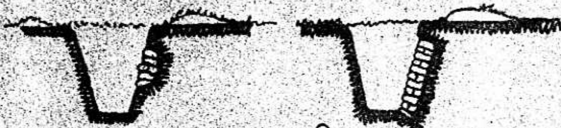
Sandsäcke fallig angelegt.
